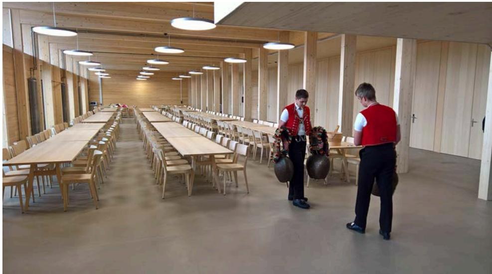
Die Holzbaustruktur des LSZG ist auch im Innern des Gebäudes wahrnehmbar. Die Unterrichtsräume, Mensa und Aula können über manuell bedienbare Klappen quergelüftet werden. Die Rasterstruktur ermöglicht eine enorme Grundrissflexibilität. Bild: Seraina Wirz
